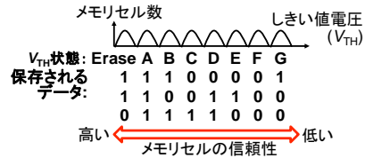
図1. 3D TLC NAND型フラッシュメモリのしきい値電圧分布と各データの割り当て
